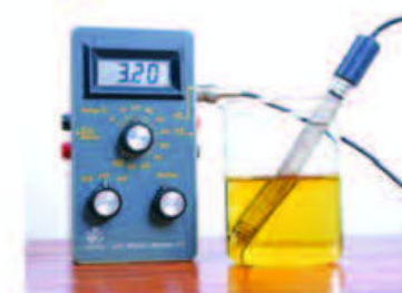
Figura 4.5 Los phmetros son en realidad potenciómetros, porque miden un potencial eléctrico de la disolución desconocida y lo comparan con otro potencial de una disolución de referencia de pH conocido.
