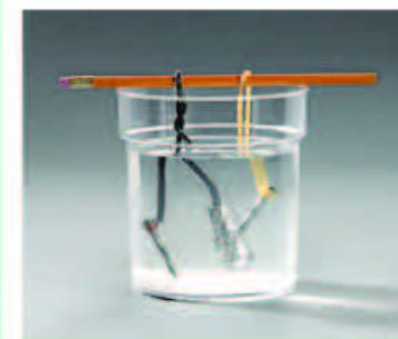
Figura 4.43 Dispositivo para probar la protección catódica.
