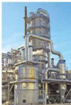
Figura 2.3 Durante la destilación del petróleo se obtienen diferentes compuestos hidrocarburos. En las torres de destilación, como las de la imagen, se va separando cada componente en cada nivel de altura de la torre. Por esto son muy altas.
