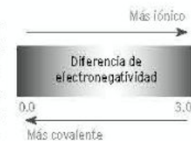
Figura 3.32 El carácter iónico o covalente de un enlace químico entre dos átomos se puede estimar de acuerdo a la escala de electronegatividad de Pauling, tomando la diferencia de electronegatividades de los átomos que participan en el enlace.
