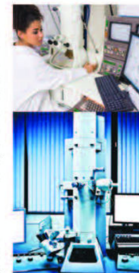
Figura 3.38 El microscopio electrónico utiliza electrones para obtener imágenes de objetos muy pequeños.
