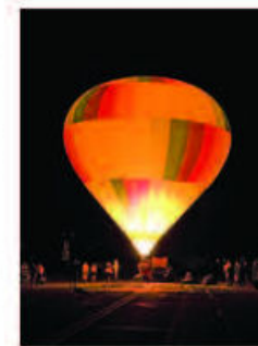
Figura 1.11 Los seres humanos aprovechamos las propiedades de los materiales. En los globos aerostáticos utilizamos la capacidad de los gases para cambiar de volumen y, por tanto, volverse más ligeros que el aire.
