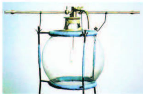
Figura 1.49 En un aparato como éste, Lavoisier realizó sus estudios sobre la combustión. Su éxito radicó en su habilidad para trabajar con un sistema cerrado que le permitía determinar la masa de los gases consumidos o producidos.
