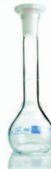
Figura 1.30 Existen matraces aforados de distintos volúmenes. La línea en el cuello del matraz indica el volumen total de la disolución.
